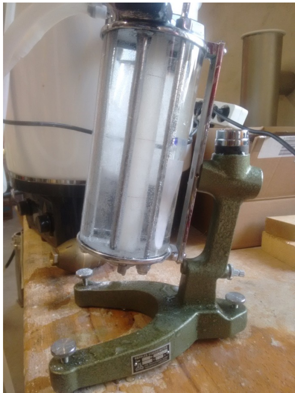
Höppler ball fall viscosimeter
